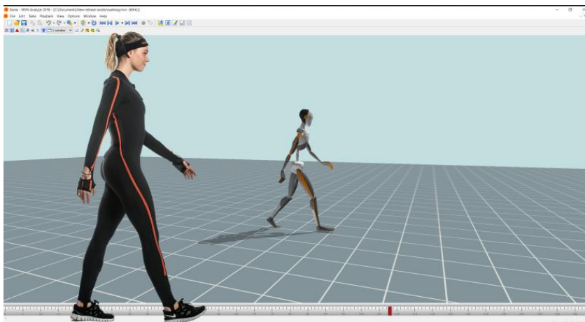
Figura 4. Sensores vestíveis (Xsens MVN) e software (MVN Animate Plus).
